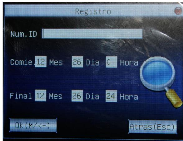
B.- En esta pantalla se pedirá ingresar el número de ID de un registro y un rango de fechas a seleccionar para que al dar presionar el botón “M/OK” se muestren los registros de ese usuario en el rango de fechas seleccionadas.
