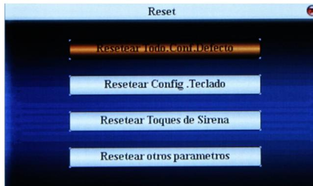
B.- Esta pantalla permite resetear las configuraciones del sistema, Configuraciones por Defecto, del Teclado, los toques de sirena o definir otros parámetros.
