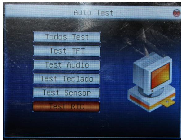
A.- Se mostrará una pantalla para checar el correcto funcionamiento del reloj del dispositivo.
